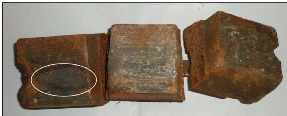
Afbeelding 20: plaatselijke blauwverkleuring (in ovaal) op remblok
