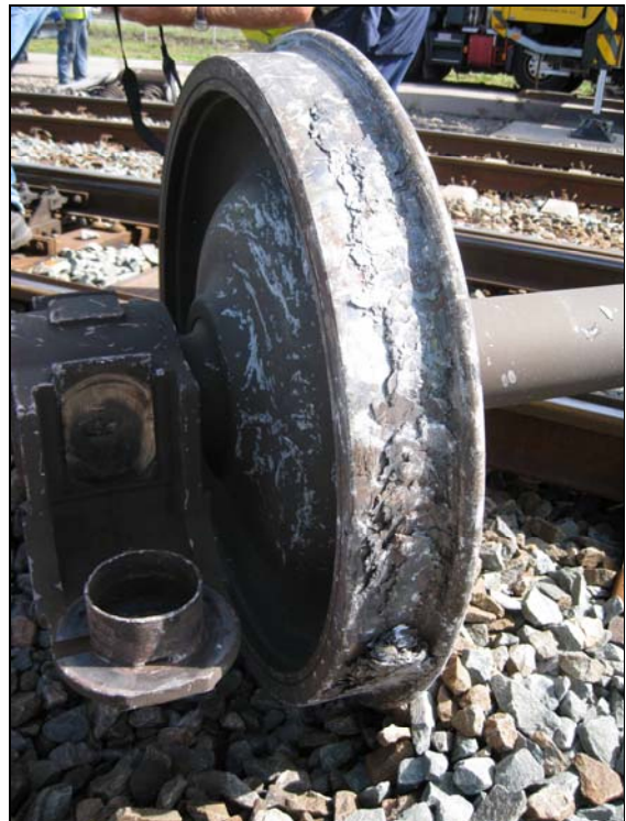
Afbeelding 34: foto van metaalopstuwing op het loopvlak van de ontsporing op 14 augustus 2008
