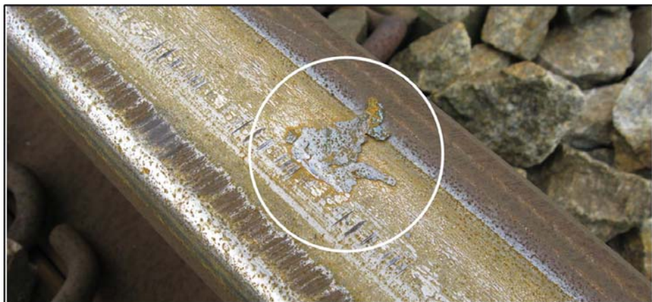
Afbeelding 12: foto van metaalschilfers en slijpgroeven op spoor KA voorafgaande aan ontsporingpunt bij km 10.3 (foto: DeltaRail)
