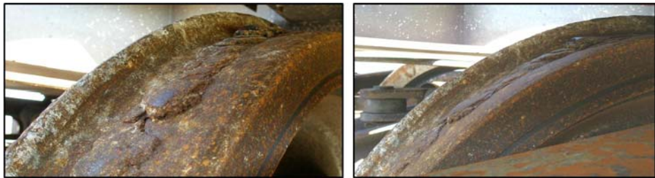
Afbeelding 17: metaalopstuwung op wielstel 3 respectievelijk 4 van wagen 8
