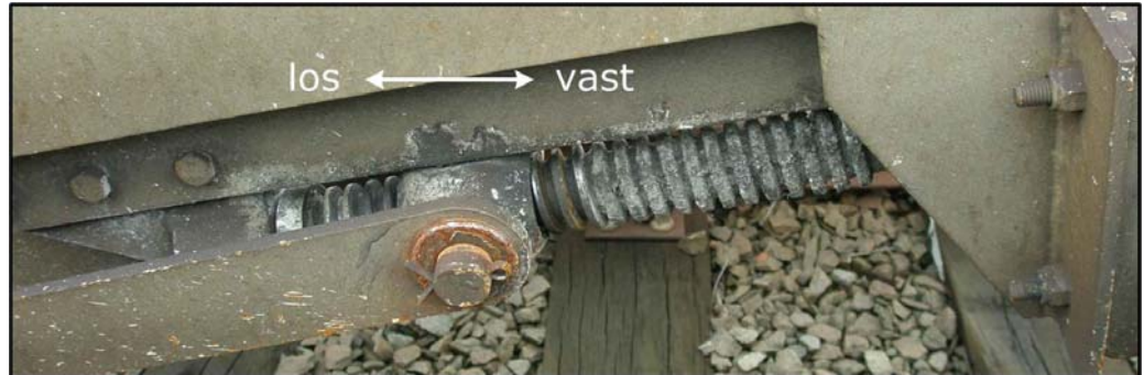
Afbeelding 21: spindel van de handrem (globaal in de stand zoals deze op 23 maart 2009 is aangetroffen)
